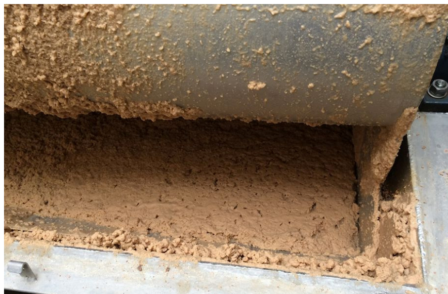
Hình 12: Chất lượng bùn sau lắng của các thiết bị KWI có độ ẩm rất thấp
