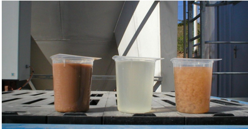
Hình 6: Bông bùn hình thành trong quá trình xử lý theo công nghệ FLOTOFILTER
